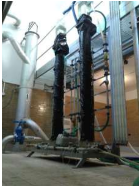
2016 - Poloprovodní zkoušky na modelovém zařízení filtru s aktivním uhlím na čerpací stanici č. 3
